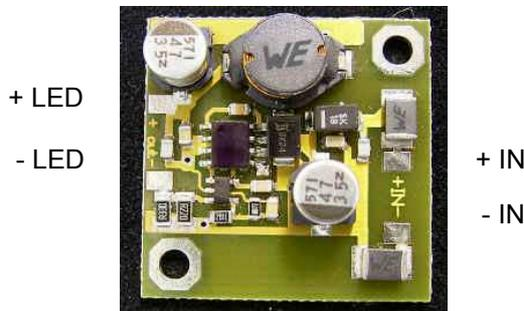
*Shutdown- Pin:* Am Shutdown- Pin befindet sich ein Löt pad, damit dieser für externe Steuerungszwecke unabhängig von der Hauptstromversorgung genutzt werden kann (TTL- kompatibel).
