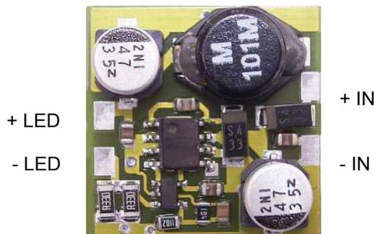
*Shutdown- Pin:* Am Shutdown- Pin befindet sich in der überarbeiteten Version der HKO ein Löt pad, damit dieser für externe Steuerungszwecke unabhängig von der Hauptstromversorgung genutzt werden kann (TTL- kompatibel).
