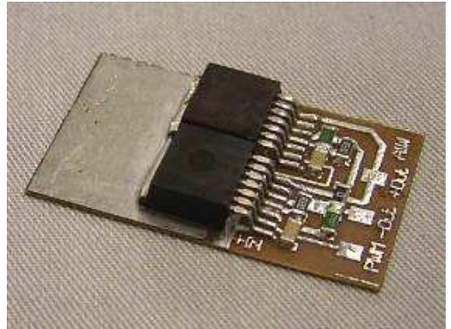
Die Differenz zwischen Eingangsspannung und Ausgangsspannung darf im ungekühlten Zustand ca. 3 Volt nicht überschreiten, sonst sinkt der Ausgangsstrom.
